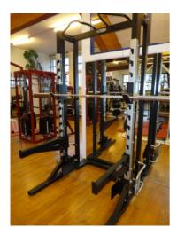
Der neue Kniebeugeständer ist ein richtiges Multitalent! Die Höhe der seitlichen Stützen kann sehr leicht eingestellt werden. Zudem können die seitlich eingehängten silberfarbigen Bügel bei den Stützen eingehängt werden. Diese können dann für Dips genützt werden. Oben hat es verschiedene Griffmöglichkeiten für Klimmzüge. Um besser an die Griffe zu kommen, hat es unten Plattformen für die Füsse, welche hochgeklappt werden können.
